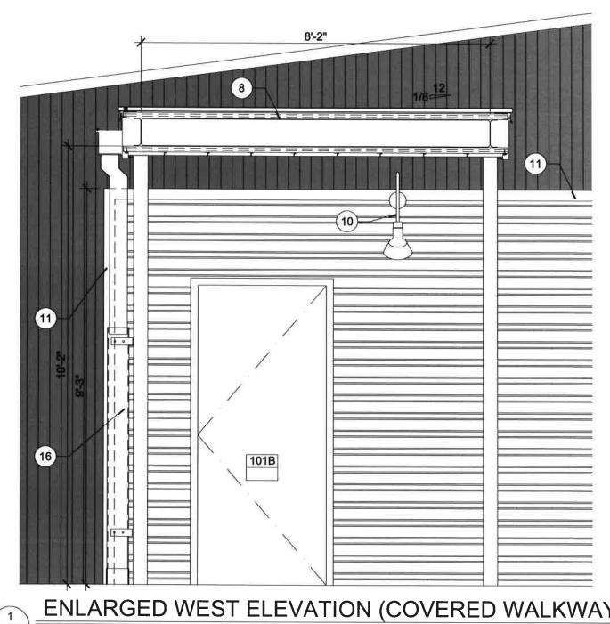
ENLARGED WEST ELEVATION (COVERED WALKWAY)
